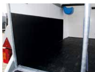
Gummisparkeplade beskytter traileren mod hestehove.
