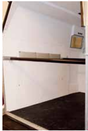
Gennemgående bom til kørsel uden skillevæg eller med skillevæggen skubbet til side.
