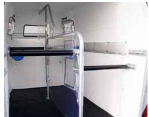
Dobbelt bomsystem gør det muligt at justere bommens højde.
